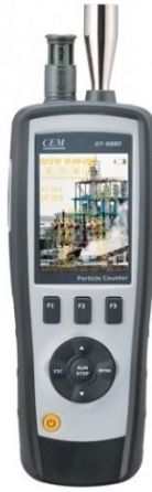
Şəkil 11.3. Toz zərrəciklərin miqdarını müəyyən edən DT 9880 hesablayıcı
